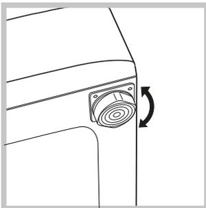
Машинаны орунга орноткондон кийин деңгээл боюнча корпустун жогорку капкагынын горизонталдуулугун текшериңиз, горизонталдын жантаюусу 2° көп болбошу керек. Жабдууну туура тегиздөө машина иштеп жаткан
