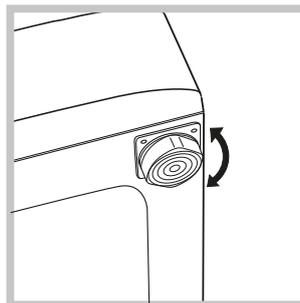
2. После установки машины на место отрегулируйте ее устойчивое положение путем вращения передних ножек (см. рис.). Для этого сначала ослабьте контргайку, после завершения регулировки контргайку затяните.
