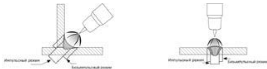
Рис. 8.10. Выделяемое тепло в импульсном и безимпульсном режимах.
