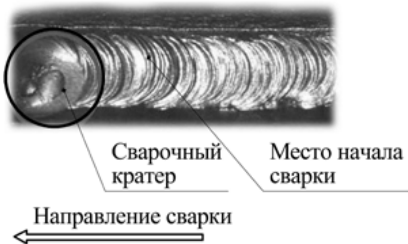
Рис. 9.4. Начало сварки при смене электрода.
