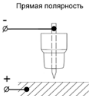
Рис. 8.6. Полярность при TIG сварке.
