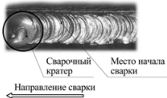
Рис. 7.5. Начало сварки при смене электрода.
