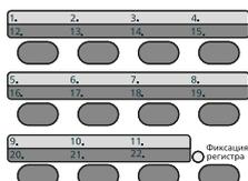
При выборе клавиш набора одним нажатием с номерами 12—22 такую клавишу следует нажимать после включения индикатора [Фиксация регистра] нажатием клавиши [Фиксация регистра].
