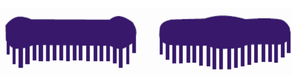
Образцы с неправильным распределением материала в факеле
