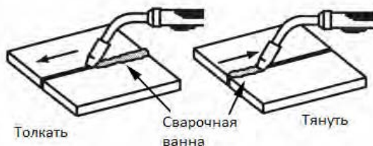
Рисунок 20. Направление движения горелки
