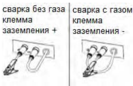
Рисунок 17. Полярность при полуавтоматической сварке
