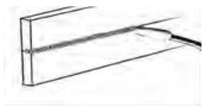
Рисунок 23. Сварка в горизонтальном положении
