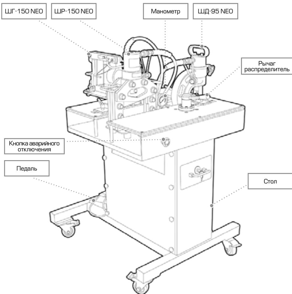
Стол **ШО NEO (КВТ)** представляет собой конструкцию, состоящую из станины, рабочей поверхности (площадки), оборудования для обработки шин, помпы и распределительного узла
