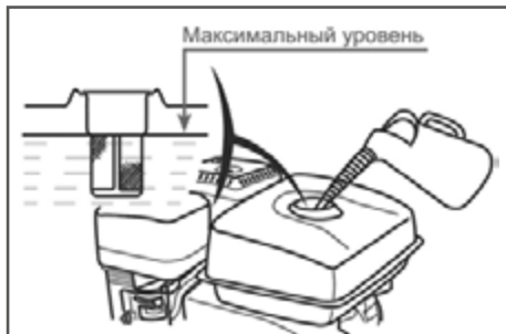
Рис. 6 Максимальный уровень топлива в топливном баке
