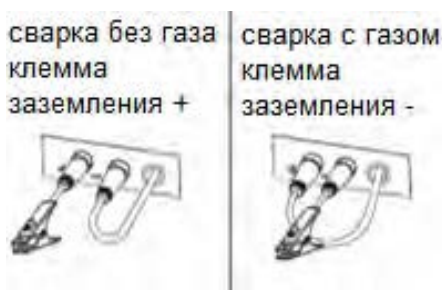
Рисунок 17. Полярность при полуавтоматической сварке
