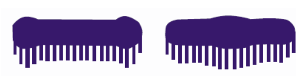
Образцы с неправильным распределением материала в факеле
