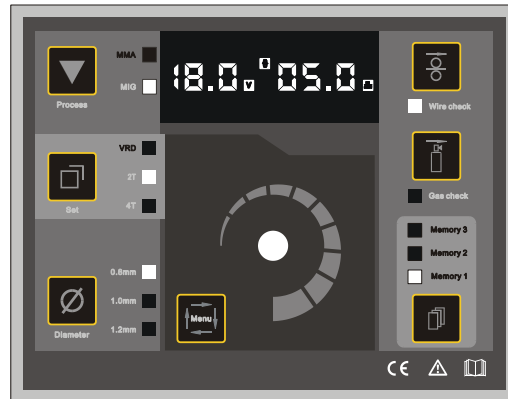
Рисунок 6: Проверка подачи проволоки в режиме MIG
