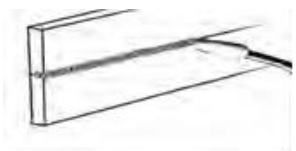
Рисунок 22. Сварка в горизонтальном положении
