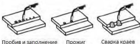
Пробив и заполнение
