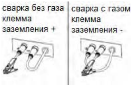
Рисунок 16. Полярность при полуавтоматической сварке
