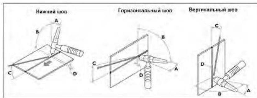
Рисунок 17. Базовые движения при работе с аргонодуговой горелкой
