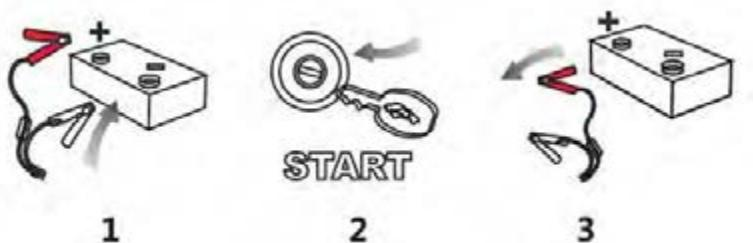
При неудачной попытке запуска двигателя следуйте следующим инструкциям:
