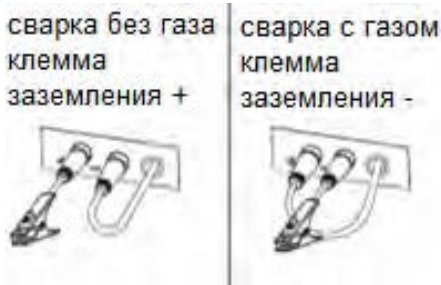
Рисунок 16. Полярность при полуавтоматической сварке
