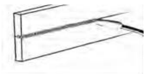
Рисунок 22. Сварка в горизонтальном положении
