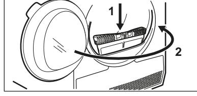
1) При необходимости удалите ворс из гнезда для фильтра и с уплотнителя. Для этого можно использовать пылесос.
