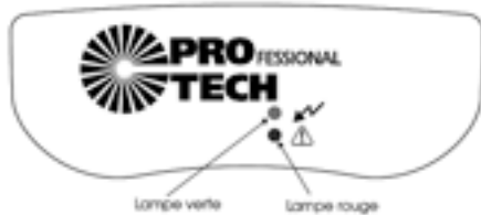
Рисунок 15 – Система PROfessional TECH: светоиндикаторы
