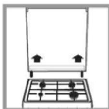
Крышку плиты следует очищать с помощью теплой воды, не используйте абразивные средства. Чтобы очистить площадь за рабочей поверхностью плиты, снимите крышку — откройте ее полностью и потяните вверх (см. рис.).
