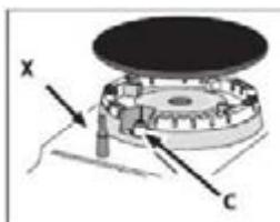
Si l'appareil est équipé d'un dispositif électronique d'allumage\* (voir figure), appuyez sur le bouton d'allumage marqué du symbole
