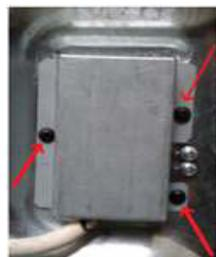
După instalarea cablului de alimentare, fixați capacul metalic cu trei șuruburi.
