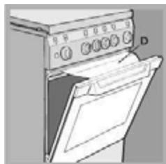
! Когда используете гриль, держите дверцу духовки приоткрытой. Чтобы предохранить рукоятки от перегрева поместите защитный экран (дефлектор) D между дверцей и панелью управления (см. рис.).
