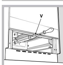
4. desurubați duza arzătorului folosind o cheie tubulară pentru duze (vezi figura) sau o cheie tubulară de 7 mm și înlocuiți-o cu cea adecvată, în funcție de tipul de gaz (vezi tabelul cu *Caracteristicile arzătoarelor și duzelor*).
