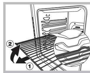
**ATENȚIE!**Cuptorul este prevăzut cu un sistem de oprire a grătarelor care permite extragerea acestora fără ca ele să iasă din cuptor(1). Pentru a extrage complet grătarele este suficient, astfel cum se arată în desen, să le ridicați, prințându-le din partea din față și să le trageți (2).
