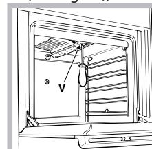
2. dévisser l'injecteur du brûleur du gril à l'aide de la clé à tube adaptée pour les injecteurs (voir Figure), ou mieux encore avec une clé à tube de 7 mm. et le remplacer par celui adapté au nouveau type de gaz (voir
