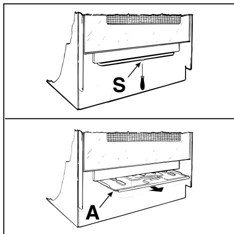
Pentru a scoate tabla de protecție „A” din aluminiu, deșurubați șurubul „S”. La încheierea operației, puneți la loc tabla de protecție și fixați-o cu șurubul „S”. Înainte de a utiliza cuptorul, verificați dacă tava de protecție „A” este fixată în poziția corectă.
