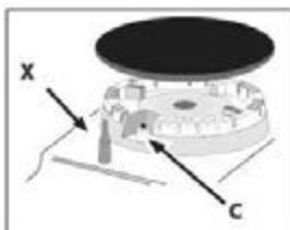
В моделях, имеющих устройство электронного зажигания\*(С), нажмите кнопку электроподжига, обозначенную символом
