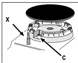
Daca aparatul este dotat cu un dispozitiv electronic de aprindere\* (C), apasati mai întâi butonul de aprindere, indicat cu simbolul **★**, apoi apasati si rotiti busonul ARZATORULUI în sens
