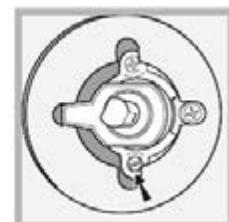
! При использовании сжиженного газа регулировочный винт должен быть закручен по часовой стрелке полностью.
