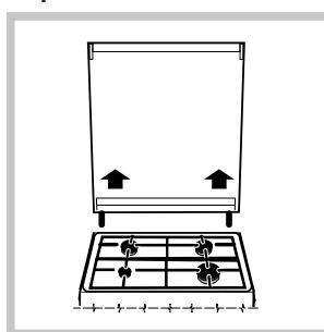
Modelele dotate cu capac din sticlă se vor spăla cu apă călduță. Evitați substanțele abrazive. Puteți demonta capacul pentru a facilita operațiile de curățare, mai ales în spatele aragazului: pentru aceasta, deschideți capacul și ridicați-l (vezi figura).
