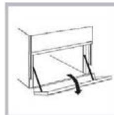
Il existe un compartiment sous le four qui sert à ranger les accessoires du four ou les plats creux. Pour ouvrir la porte, tirez-la vers le bas (voir figure).
