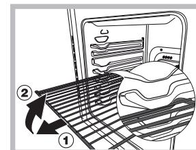
**ВНИМАНИЕ!** Духовой шкаф укомплектован системой блокировки решеток, позволяющей вынимать их из духовки не полностью (1). Для полного вынимания решеток достаточно по днуять их, как показано на схеме, взяв их за передний край, и потянуть на себя (2).
