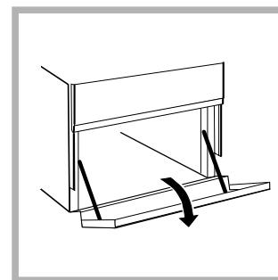
Снизу духового шкафа имеется отсек, который может быть использован для хранения кухонных принадлежностей или кастрюль. Для открывания дверцы поверните ее вниз (см. рисунок).
