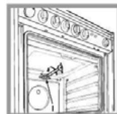
2) специальным торцевым ключом для жиклеров или 7 мм торцевым ключом (см. рис.) отвинтите жиклер горелки гриля и замените его подходящим для нового типа газа (см. табл. Характеристики горелок и жиклеров).
