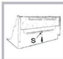
Pour retirer la protection coulissante, retirez la vis S (voir figure). Pour la remettre en place, verrouillez à l'aide de la vis S.
