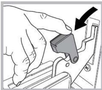
3. Эшикти, шарнирлер токтогучча жаап, (эшик болжолу менен  $40^\circ$  ачык болушу мүмкүн) (сүрөттү караңыз)
