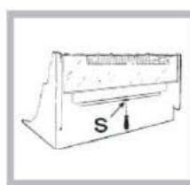
Pour retirer la protection coulissante, retirez la vis S (voir figure). Pour la remettre en place, verrouillez à l'aide de la vis S.
