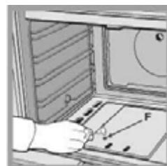
Чтобы зажечь горелку духовки, поднесите горящую спичку или зажигалку к отверстию «F» (см. рис.), нажмите и поверните рукоятку управления духовкой против часовой стрелки в положение Max.
