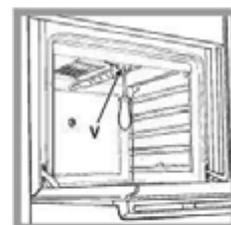
1) отверните винт «V» и снимите горелку (см. рис.);
