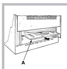
3. extindeți arzătorul cuptorului după ce ati scos șurubul V (vezi figura);
