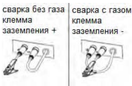
Рисунок 16. Полярность при полуавтоматической сварке
