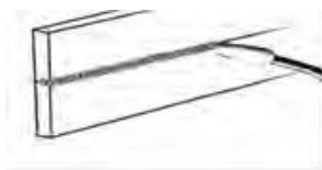
Рисунок 22. Сварка в горизонтальном положении
