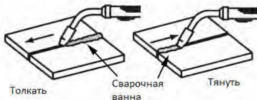
Рисунок 19. Направление движения горелки
