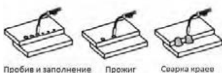
Рисунок 26. Методы MIG сварки точками.
