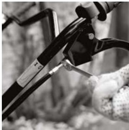
Со временем тросы привода могут растянуться. Для их регулировки необходимо расконтрить гайку и добиться оптимального натяжения тросов.
