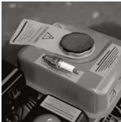
Проверяйте состояние свечи зажигания каждые 25 моточасов работы. Регулярно чистите свечу зажигания и проверяйте зазор между электродами. Зазор должен быть 0,6-0,7 мм.
