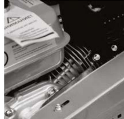
Регулярно очищайте от загрязнений (почва, остатки травы, масло) ребра цилиндра кисточкой и/или баллоном со сжатым воздухом.
