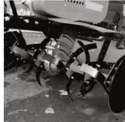
Каждый раз перед началом культивации проверяйте состояние редуктора, вала редуктора, фрез и креплений. При наличии масляных пятен на редукторе или вале обратитесь в сервисный центр. Если фрезы пришли в негодность, закажите новые.
