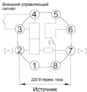
Рис. 12: Схема проводных соединений JSZ3K (220 В)
