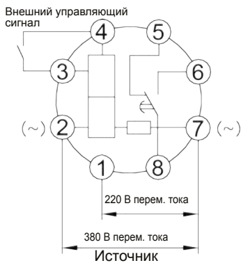
Рис. 11: Схема проводных соединений JSZ3K (380 В, 220 В)
