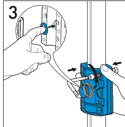
3. Установить хомут (седёлку) на место, уплотнив кольцом и стянув шестью болтами и гайками, шестигранником (5 мм) по часовой стрелке. Убедиться, что в месте соединения хомута со сливной частью нет посторонних частиц.
