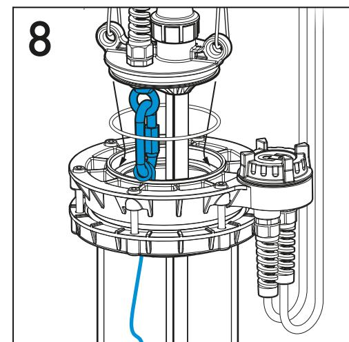
8. Второй конец шнура зафиксировать на карабине оголовка или поверхности так, чтобы он не был натянут и имел 80 - 100 см свободного хода.
