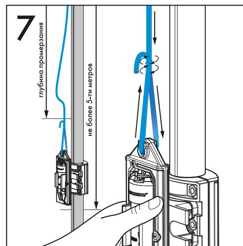
7. Крепко закрепить на верхней проушине сливной части шнур из синтетического материала.
