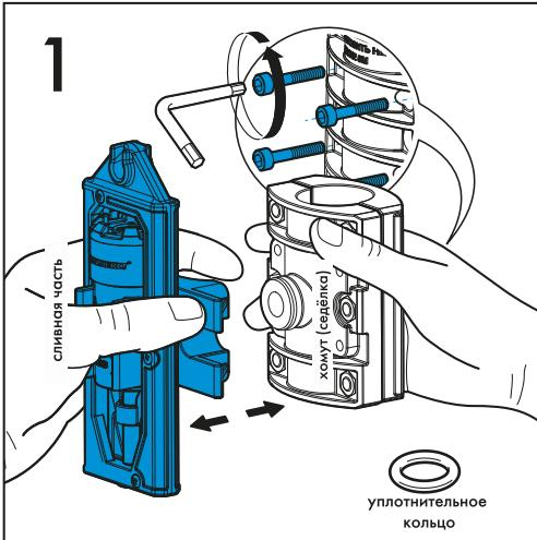
1. Сливной клапан поставляется в сборе, перед монтажом необходимо отсоединить хомут (седёлку) от сливной части, открутив четыре винта шестигранником (3 мм), по направлению против часовой стрелки.
