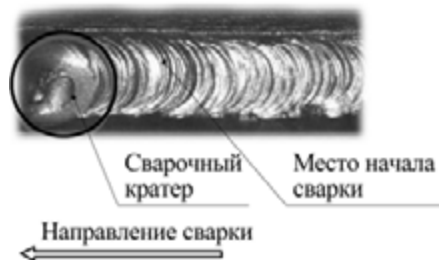
Рис. 7.4. Начало сварки при смене электрода.
