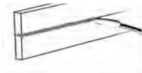
Рисунок 21. Сварка в горизонтальном положении
