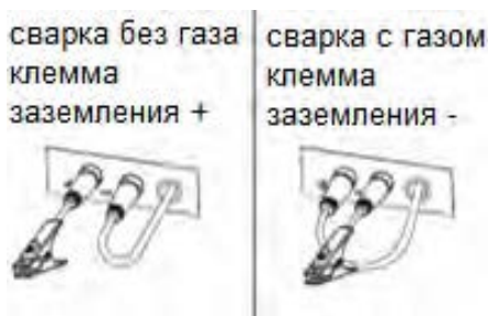
Рисунок 15. Полярность при полуавтоматической сварке
