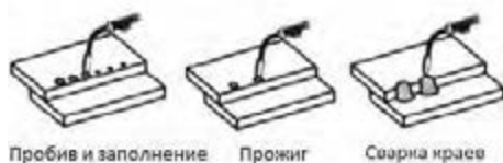
Рисунок 25. Методы MIG сварка точками.
