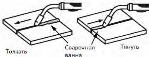
Рисунок 18. Направление движения горелки
