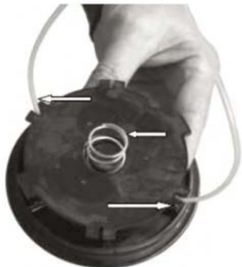
Намотайте корд плотно с натягом по часовой стрелке в пазы на катушке. Вставьте концы лески в пазы на корпусе катушки. Убедитесь в наличии пружины в катушке.
