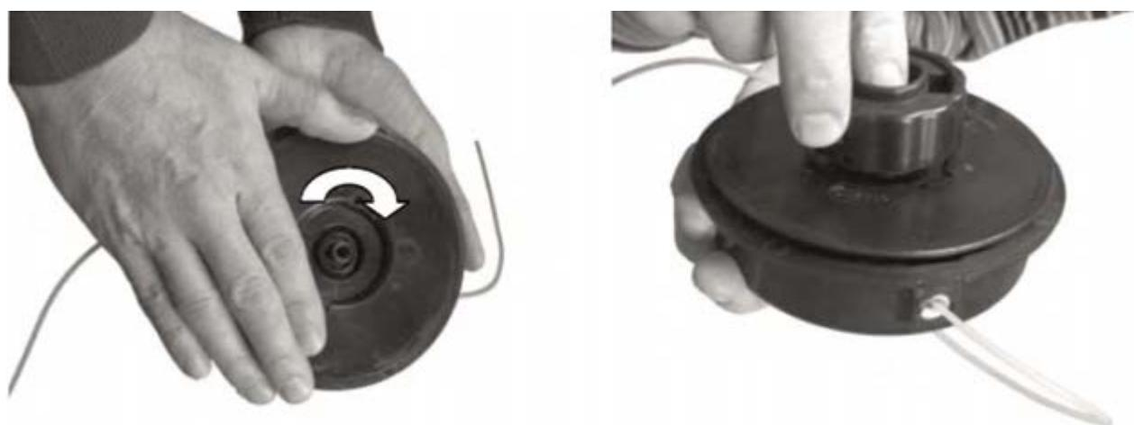
Поверните катушку по часовой стрелке примерно на 10 градусов и зафиксируйте ее в корпусе. Закрутите гайку крепления катушки.
