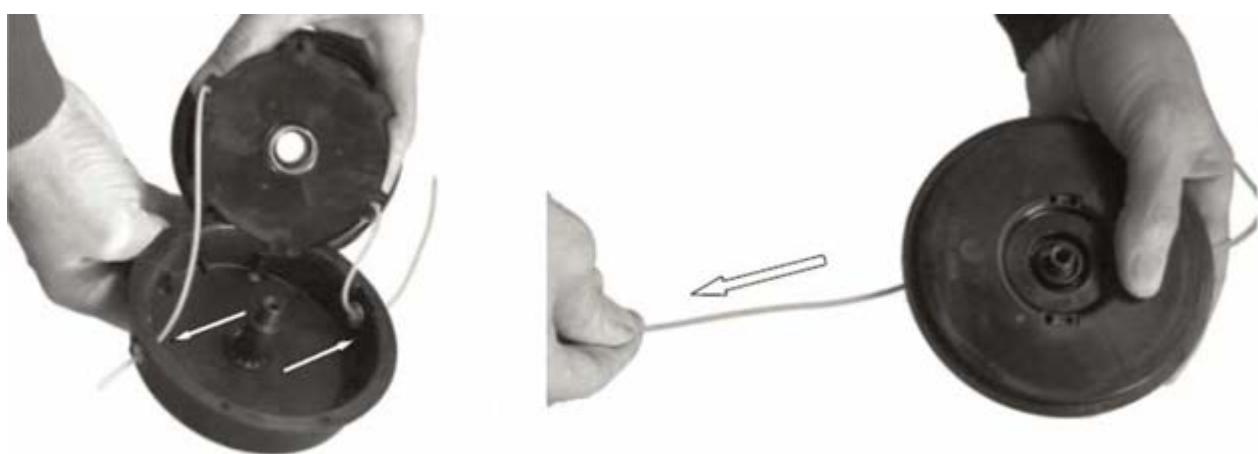
Вставьте концы лески в отверстия на корпусе катушки и установите катушку в корпус. Освободите концы корда, потянув за концы от центра, при этом нажимая вниз на катушку.
