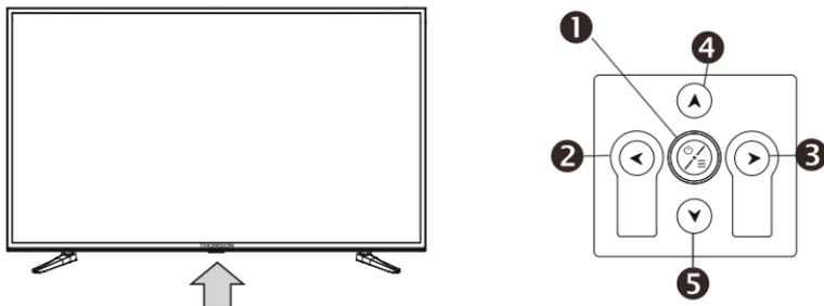
Рис. Расположение панели кнопок управления
