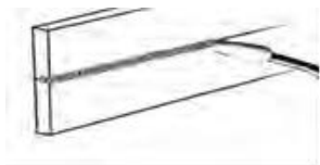
Рисунок 22. Сварка в горизонтальном положении
