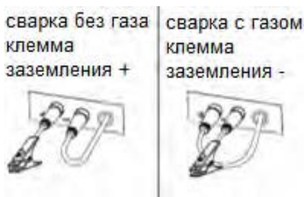
Рисунок 16. Полярность при полуавтоматической сварке
