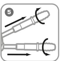
**Установите необходимую длину и зафиксируйте их, повернув в противоположную сторону**
