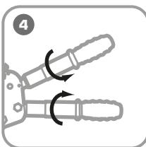
**Расфиксируйте рукоятки, повернув их вокруг оси**
