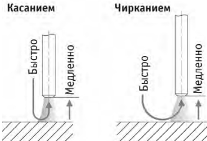
Рис. 9.1. Способы зажигания сварочной дуги.
