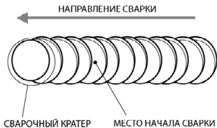
Рис. 9.4. Начало сварки при смене электрода.
