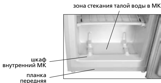
Рисунок 7 — Сбор талой воды из МК
