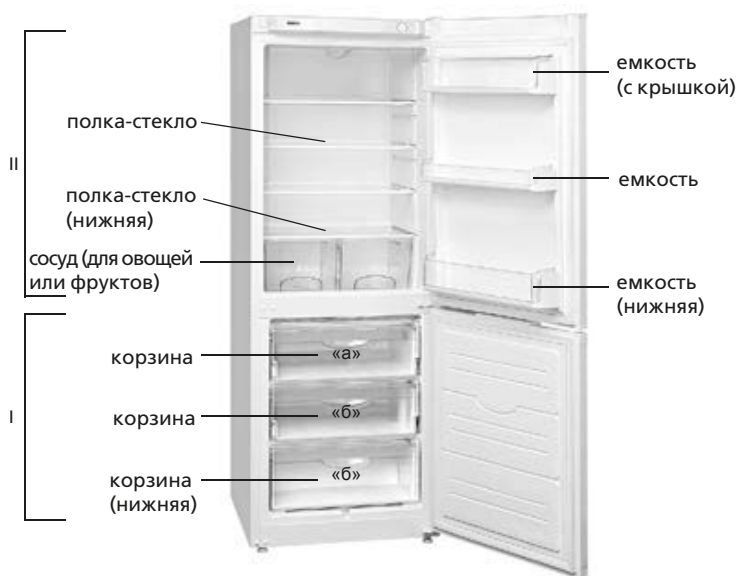
ерш форма для льда винт вкладыш для яиц лопатка упор задний I — морозильное отделение (МО): «а» — зона замораживания и хранения; «б» — зона хранения; II — отделение для хранения свежих пищевых продуктов (ХО)
