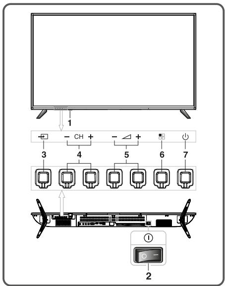
1. Светодиодный индикатор включения питания и окно приема сигнала дистанционного управления.
