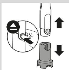
**12** Снимите привод, нажав и отпустив кнопку отсоединения.
