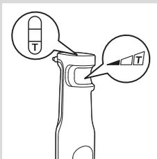
Этот прибор оснащен переключателем и индикатором скорости в верхней части устройства.
