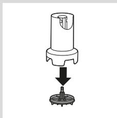
**13** Снимите вращающуюся пластину с привода.
