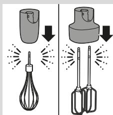
**1** Прикрепите венчик к приводу венчика или насадку-миксер к приводу насадки-миксера (должен прозвучать щелчок).
