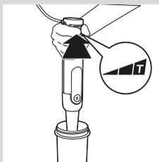
**5** Включите прибор нажатием на переключатель. Вы можете увеличить скорость работы прибора сильным нажатием на переключатель.
