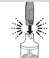
**4** Прикрепите блок электродвигателя к приводу измельчителя XL (должен прозвучать щелчок).
