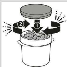
**10** Установите крышку и закройте ее, повернув по часовой стрелке.
