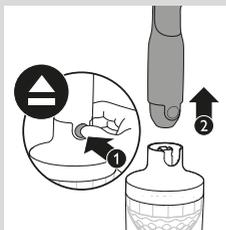
**8** Нажмите кнопку отсоединения, чтобы отсоединить блок электродвигателя от привода.
