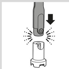
**4** Прикрепите блок электродвигателя к приводу (рис. 2).
