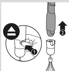
**9** Нажмите кнопку отсоединения, чтобы отсоединить блок электродвигателя от привода.
