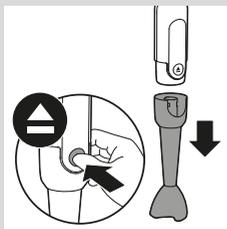
**8** Снимите насадку для смешивания, нажав кнопку отсоединения.
