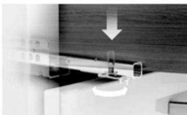
Выдвижной ящик под наклоном насаживается сверху на выдвинутые направляющие. В два отверстия на задней стенке выдвижного ящика вставляются задние крюки направляющей. Надавив на выдвижной ящик, его соединяют с цапфами. Сужающиеся кверху цапфы обеспечивают точность и плотность посадки. Для демонтажа выдвижной ящик выдвинуть до упора, слегка приподнять и снять.
