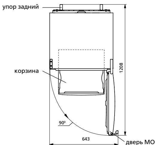
Рисунок 2 – Холодильник (вид сверху)
