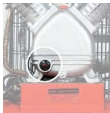
1 – маслозаливное отверстие 2 – масляный сапун
