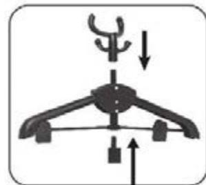
5. Установите вешалку с держателем утюжка на телескопическую стойку, как это показано на рисунке. Раздвиньте плечики у вешалки и установите их в соответствующие пазы у основания вешалки.
