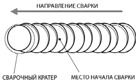
Рис. 10.4. Начало сварки при смене электрода.
