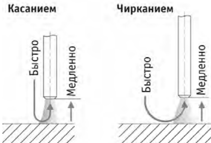
Рис. 10.1. Способы зажигания сварочной дуги.
