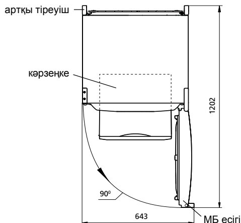
2-сурет – Тоңазытқыш (үстінен қарау)
