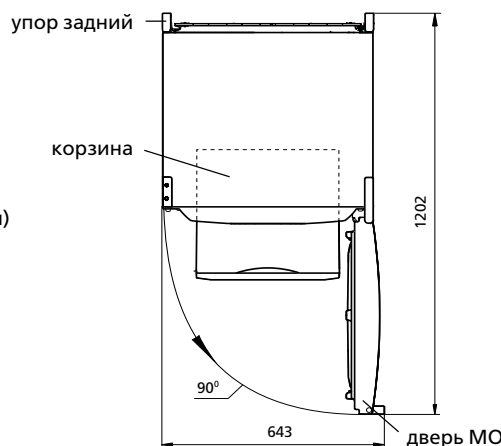
Рисунок 2 – Холодильник (вид сверху)
