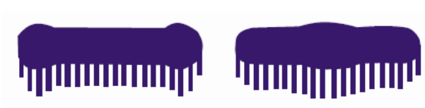
Образцы с неправильным распределением материала в факеле
