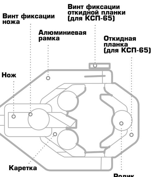
Инструмент комплектуется двумя видами ножей, один из них - нож для снятия полупроводящего слоя, другой - для снятия слоя изоляции из щитого полиэтилена (СПЭ). Кабель размещается в рабочей зоне инструмента, нож устанавливается на необходимую, допустимую глубину, после чего инструмент вращается на роликах вокруг оси кабеля. Инструмент КСП-65 имеет откидную рабочую голову, что позволяет упростить установку кабеля в рабочей зоне
