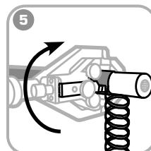
Вращая инструмент за рукоятку вокруг кабеля по спирали, снимите полупроводящий слой.
