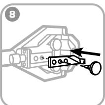
Установите нож для снятия изоляции из СПЭ.
