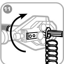
Вращая инструмент за рукоятку вокруг кабеля по спирали, снимите изоляцию на необходимую длину.
