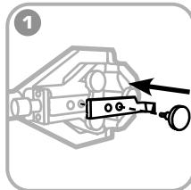
Установите нож для снятия полупроводящего слоя.
