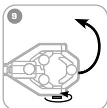
Поверните винт фиксации откидной планки. Откиньте планку, установите кабель в инструмент, закройте планку и зафиксируйте винтом.
