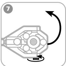
Поверните винт фиксации откидной головки, и снимите инструмент с кабеля.
