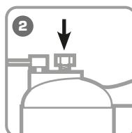
Установите помпу под углом 30° заливной пробкой вверх и открутите винт для сливания воздуха. Для помпы ПМН-7012 произвести установку педали в рабочее положение.
