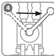
После завершения рабочего цикла поверните распределитель в крайнее правое положение. При этом давление в исполняющем инструменте №1 полностью сбрасывается.
