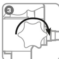
**Поверните винт сброса давления в положение «Закрыть»**
