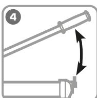
**Нагнетайте давление масла рукояткой/ педалью до завершения операции (при опрессовке - смыкание матриц, при резке - полное перерезание кабеля или до срабатывания АСД)**
