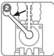
Для подачи давления на инструмент №1 установите распределитель в крайнее левое положение
