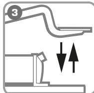
Нагнетайте давление педалью до завершения операции (при опрессовке - смыкание матриц, при резке - полное перерезание кабеля или до срабатывания АСД)
