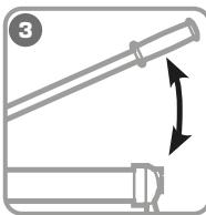
Нагнетайте давление рукояткой до завершения операции (при опрессовке - смыкание матриц, при резке - полное перерезание кабеля)
