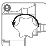
**После завершения рабочего цикла сбросьте давление, повернув винт сброса давления в положение «Открыть»**
