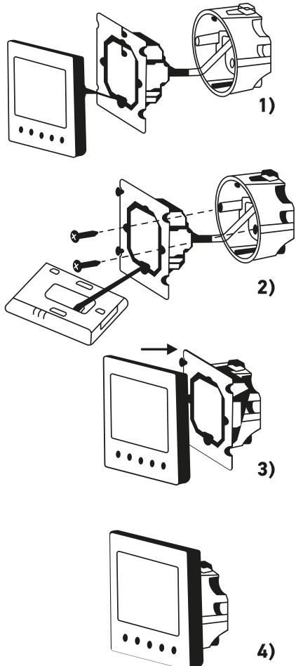
1. Подключите провод питания, провод нагревательного оборудования (нагрузка) и выносной датчик к соответствующим клеммам.
