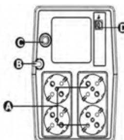
**A - Розетки****В - Вход переменного тока****С - Предохранитель / выключатель (опция)****D - USB порт (опция)**
