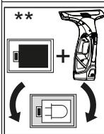
Akumulator wymienny i urządzenie należy włożyć jednocześnie do stacji ładowania
