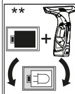
Placer la batterie de recharge et l'appareil en même temps dans la station de charge
