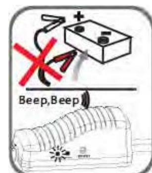
**ГОРИТ КРАСНЫЙ СИГНАЛ, ЗВУЧИТ СИГНАЛ ТРЕВОГИ:** Подключение неправильное, звучит сигнал тревоги, необходимо проверить правильность подключения зажимов. Для снятия сигнала тревоги необходимо выключить устройство и включить спустя 30 сек. После появления зеленого сигнала можно заводить двигатель.
