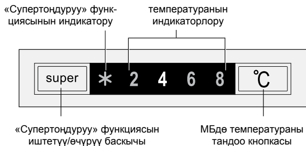
3-сүрөт – Башкаруу панели
