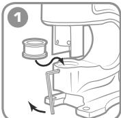
Установите матрицу в посадочное отверстие в корпусе. зафиксируйте винтом.
