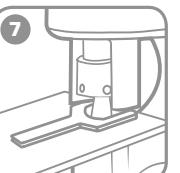
Установите съемник между упором и шиной. Аккуратно снимите шину с пуансона.
