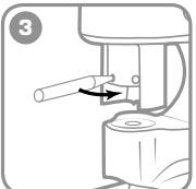
Зафиксируйте пуансон гайкой, используя вороток (ШД-95). Гайка ШД-110 затягивается от руки
