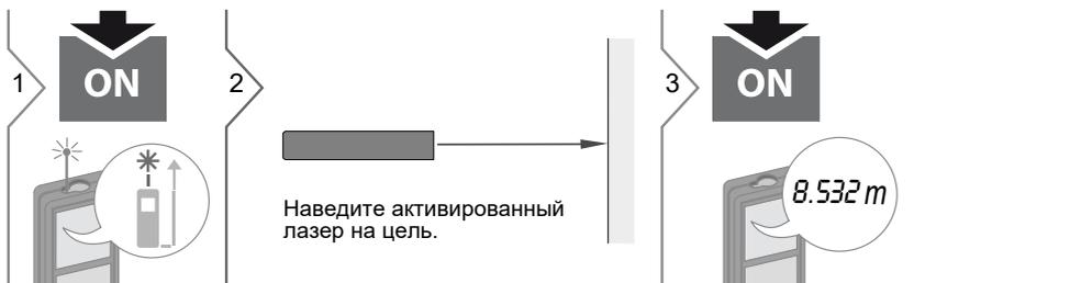
**i** Целевые поверхности: Ошибки при измерениях могут возникнуть в случае выполнения измерений до таких поверхностей, как бесцветные жидкости, стекло, стиропфом, матовые полупрозрачные поверхности или при наведении на очень блестящие поверхности. При наведении на темные поверхности время измерения увеличивается.
