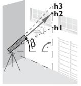
Направьте лазер на верхние точки и отслеживание угла/высоты начнется автоматически.
