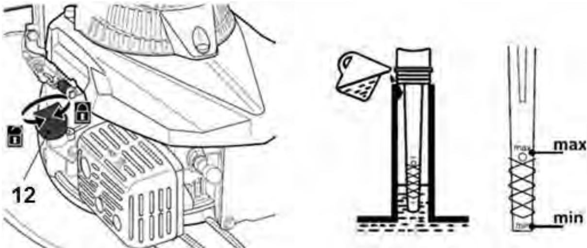
**ВНИМАНИЕ!** При вводе в эксплуатацию новой газонокосилки первую замену масла необходимо произвести после 5 моточасов работы. Каждая последующая замена через 50 моточасов, согласно графика ТО при нормальных условиях эксплуатации.
