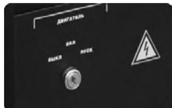
(c) Установите выключатель в положение «ВЫКЛ».
